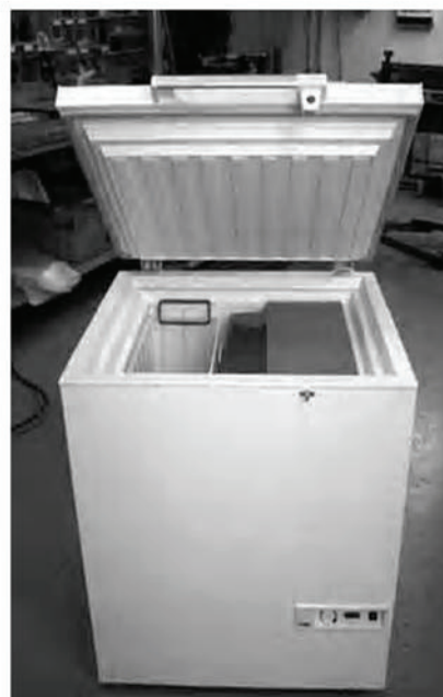
Фото1: Опытный образец охладителя вакцин. Вакцина будет находиться в трех корзинах, размещенных вертикально в левой части корпуса. Хранилище льда размещено под синей крышкой с правой стороны фотографии. Компрессор размещен под хранилищем льда.
