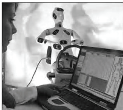
Тепловой манекен, применяемый для оперативного измерения температуры и уровня температурного комфорта. Изготовлен фирмой SixTau по лицензии Центра исследований Фиат
