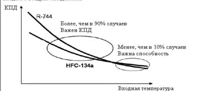
Рис. 1. Типичная кривая эффективности (КПД) при различных температурах входного воздуха охладителей
